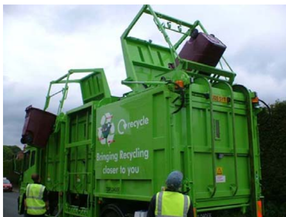
Figura 5.2-8:Colectoare trei fractii separate fara compactare
