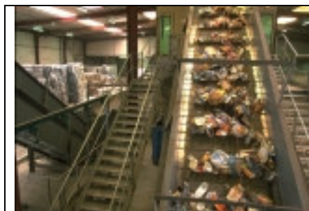
Fig 6.9 instalație de sortare ce arată deșeuri uscate presortate gata pentru reciclare
